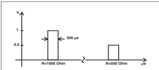
La amplitud máxima de la corriente liberada depende de la resistencia de carga y el campo de duraciones seleccionados, tal y como se indica en la siguiente figura.
