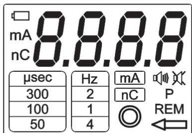
Il display è utilizzato sia per la visualizzazione della corrente o della quantità di carica associate ad ogni impulso sia per la visualizzazione dei parametri selezionati (durata impulso, frequenza, unità di misura della visualizzazione, pulsante di selezione, stato della batteria). Il parametro visualizzato corrisponde alla grandezza realmente erogata dall'apparecchio, salvo quando si
