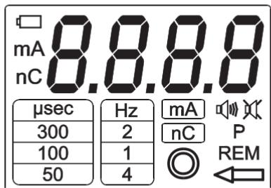
L'écran est utilisé pour afficher soit l'intensité de courant (mA), soit la charge associée à chaque impulsion (nC) ainsi que les paramètres de fonctionnement sélectionnés (durée de l'impulsion, fréquence, unité de mesure de visualisation, bouton de contrôle du courant activé, éventuelles alarmes concernant la batterie).
