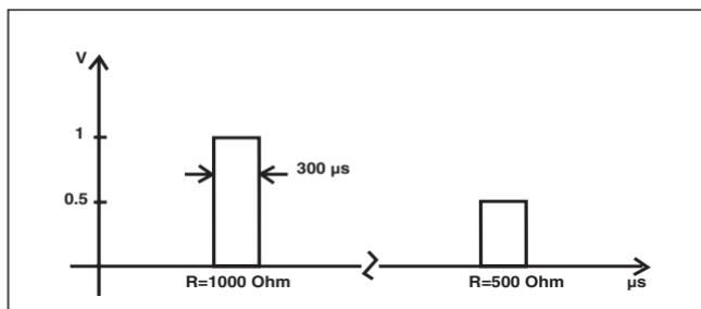
Die maximale Stromzufuhr hängt – wie die folgende Abbildung zeigt - vom Widerstand und von der gewählten Impulsdauer ab:
