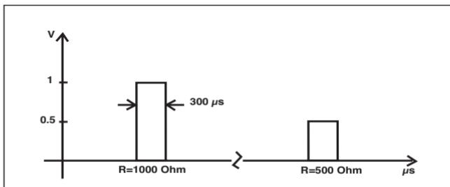
L'amplitude maximum du courant délivré est fonction de la résistance de charge et de la plage de durées sélectionnées, comme indiqué sur la figure ci-dessous.
